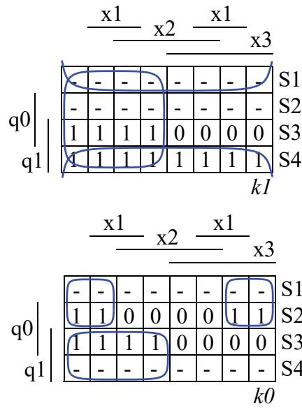
Nagu näha, on minimeeritud siirdefunktsioonid identsed Moore automaadi omadega (vt. alamülesanne 2):  $j_1 = q_0$ ,  $k_1 = \bar{q}_0 + \bar{x_3}$ ,  $j_0 = x_1 \bar{q}_1$ ,  $k_0 = \bar{x_2} \bar{q}_1 + \bar{x_3} q_1$ .
