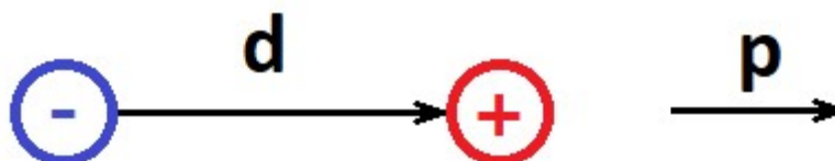
Joonis 1. Elektriline dipool ja selle dipoolmoment \mathbf{p}
