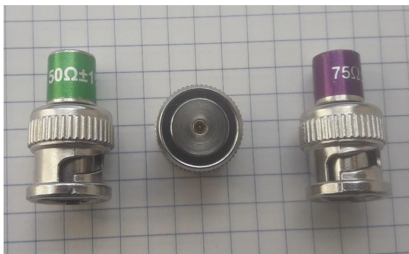
Joonis 8. Töös kasutatavad terminaatorid ja BNC lühis (keskel)
