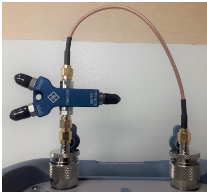
Joonis 3. Kalibreerimiskomplekti ühendamine ülekande kalibreerimiseks
